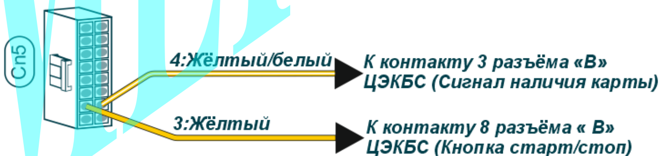
Схема. 4: Подключение цепей автозапуска (автомобиль без ключа).
