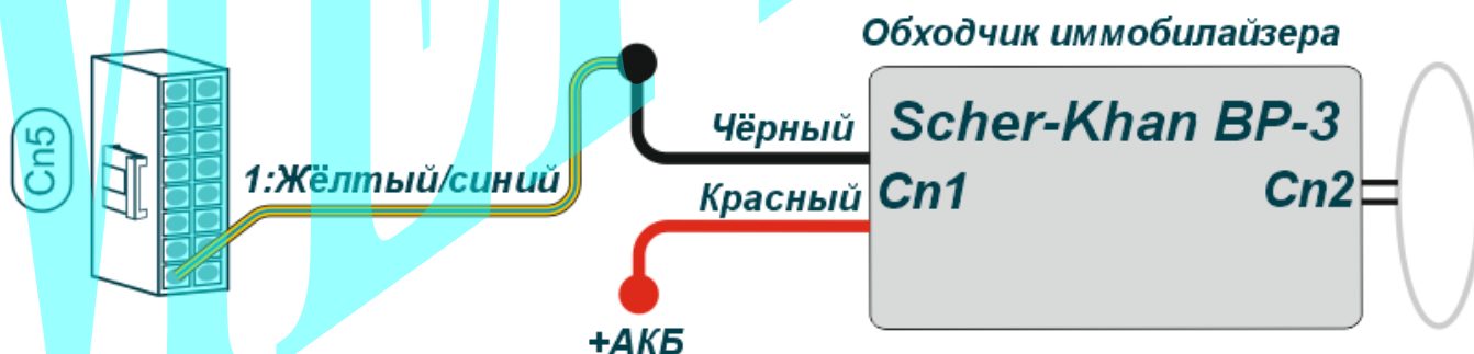
Схема. 7: Подключение обходчика иммобилайзера.
