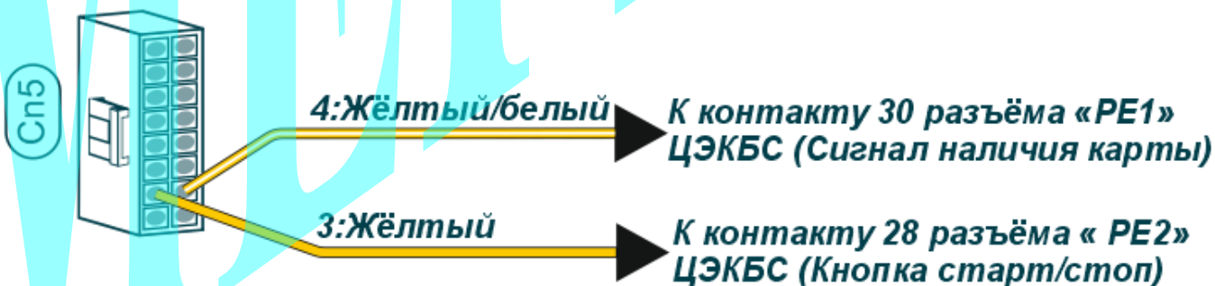
Схема. 4: Подключение цепей автозапуска.
