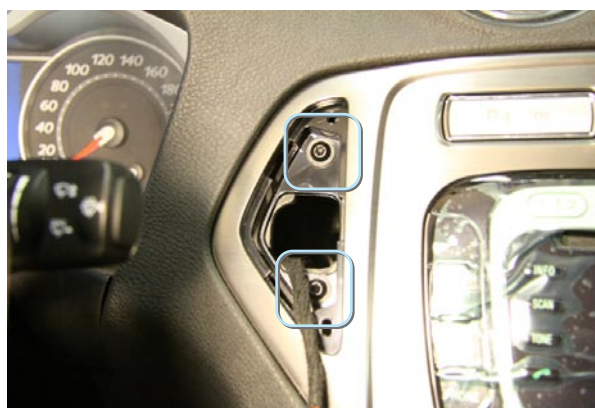
Фото 3.4. Крепление облицовки магнитолы
