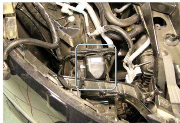
Фото 6.4. Сирена (крепление на 2 самореза)
