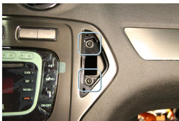
Фото 3.5. Крепление облицовки магнитолы
